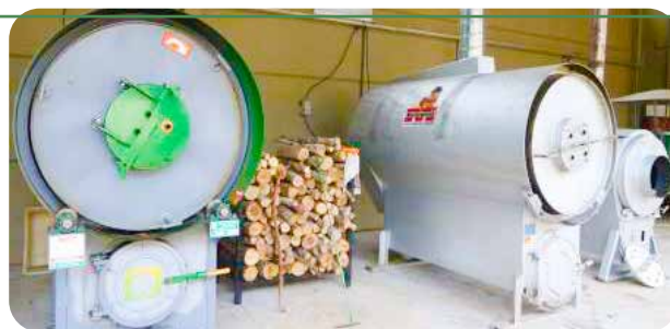
Modelos de desidratadores de carcaças de suínos e aves. Os equipamentos utilizam lenha para aquecimento e energia elétrica para movimentação do cilindro rotativo. Laboratório TEC-DAM, Embrapa Suínos e Aves, 2017. Foto: Gustavo J.M.M. de Lima/Embrapa.
